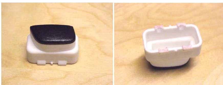
Bild 2.1 Blindplugg framtagen i SLS
