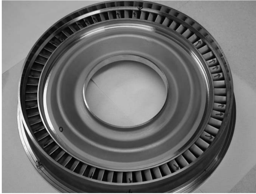
Stator 2 med ledsidan av skenorna/skovlarna/kanalerna synlig.
