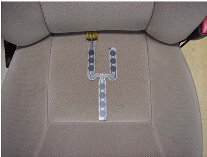
Figur A1 Tryck/böjsensor placerad på sätesdyna.
