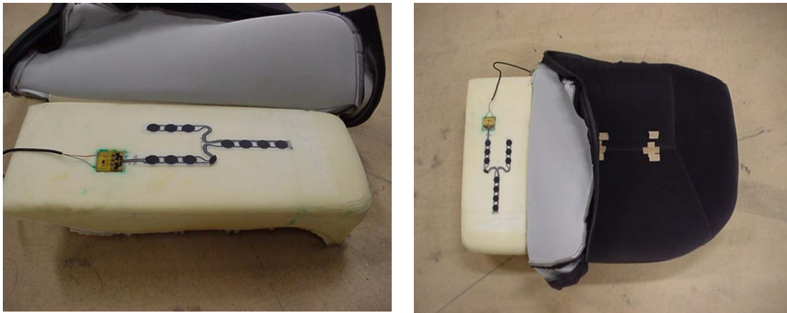
Figur G1a & G1b Sensor typ 1 placerad på skumdyna på mittplats baksäte.
