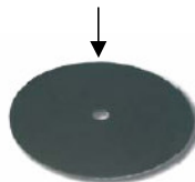
Bild 2 Under varje palett sitter en s.k. RFID-bricka med sin egna unika identitet. Bilden nedan illustrerar en sådan RFID-bricka.
