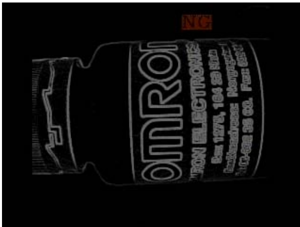
fig. 8 Kamera 1 som kontrollerar att etikett finns, inte är trasig och att den inte är felplacerad
