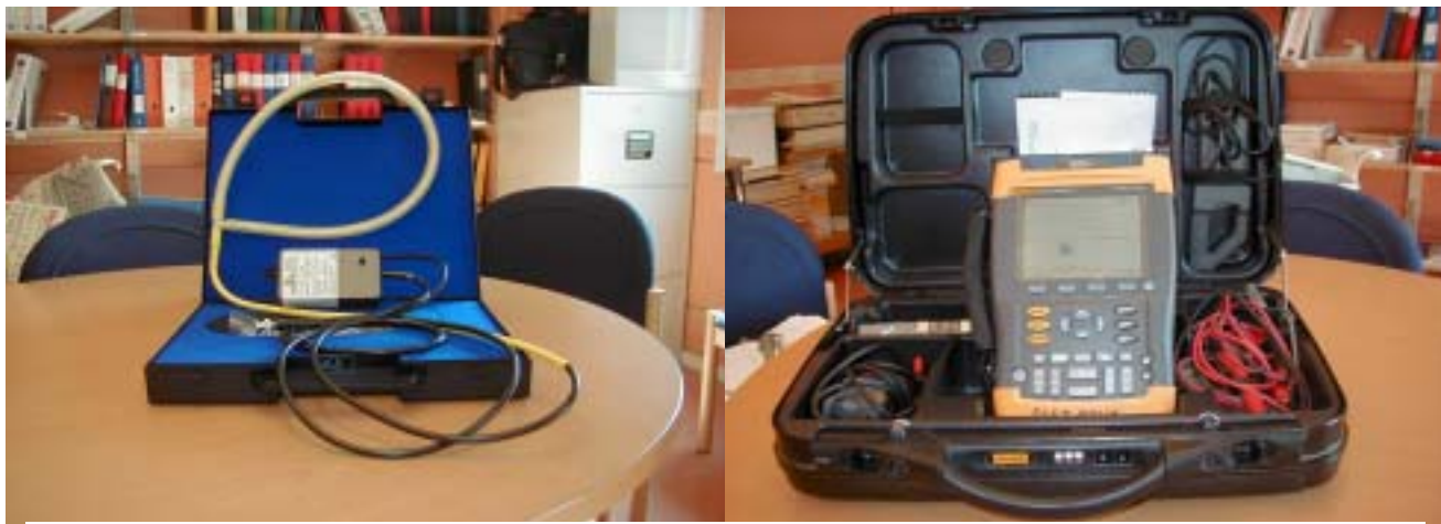
Bild 6-2 Till vänster ser vi Rogowski spolen och till höger det portabla oscilloskopet.
