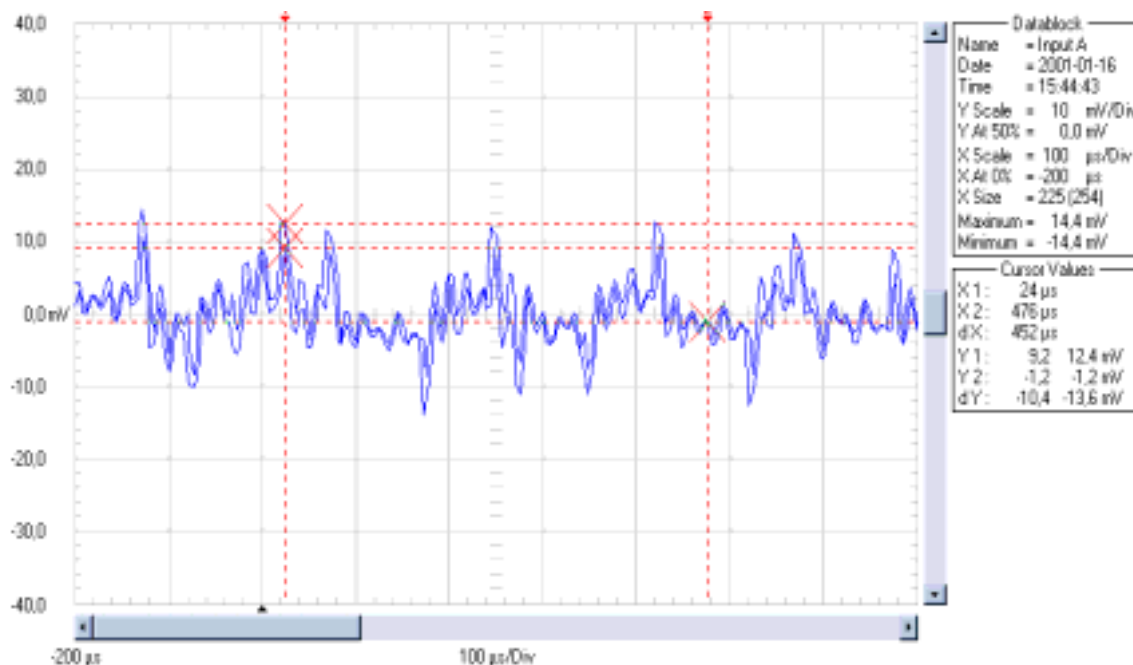
Bild 5-2 Visar summaströmmen i de tre faserna vid frekvensomriktardrift och lagerströmsproblem. Mätning enligt metod b) ovan (Bild ABB)
