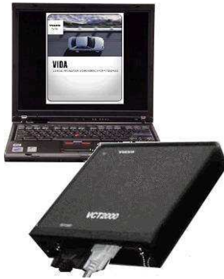
Figur 4.1 – VCT-2000 och programmet VIDA installerat på en persondator [3]
